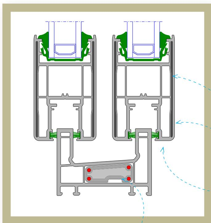
iSlide#neo est né de l'idée de supprimer les renforts acier à l'intérieur des chambres des profilés. Une réelle avancée technologique qui permet d'atteindre des performances d'isolation exceptionnelles, une grande stabilité des profilés couleur, et une rigidité parfaite même sur les grandes dimensions.
